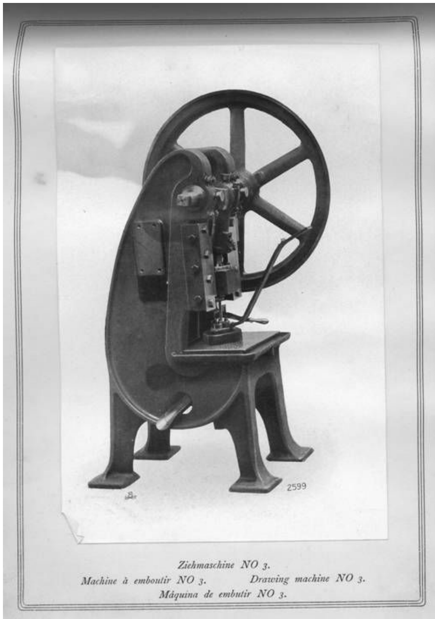
Hülsenzziehmaschine der Deutschen Waffen- und Munitionsfabriken AG, Berlin und Karlsruhe, um 1900.
